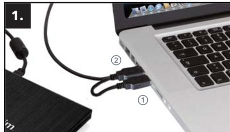
Conecte el cable USB en Y al puerto de interfaz de la computadora.
